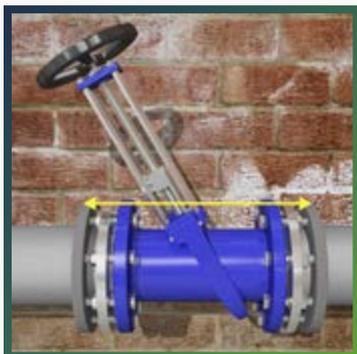
Произведите монтаж теплоизоляции на прямых участках трубопровода до вентиля. Вырежьте два изоляционных кольца необходимого размера и смонтируйте их у внешних сторон каждого из фланцев, соединив разрезанные концы с помощью клея THERMAFLEX (более подробно см. инструкцию в п. 8.14). Измерьте расстояния между внешними поверхностями смонтированных изоляционных колец, а также от поверхности каждого кольца до горловины вентиля.
