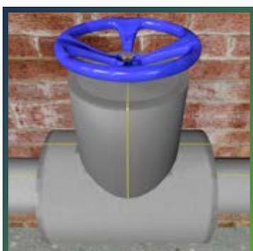
Через 2-12 минут, когда клей подсохнет (перестанет прилипать к пальцам), осторожно соедините края изоляции. При необходимости используйте монтажные клипсы THERMACLIPS. Через 24 часа, после полного высыхания клея, снимите клипсы и проклейте швы скотчем POLYKEN для герметизации соединений.
