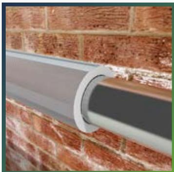
Расстегните замок-защелку на теплоизоляционной трубке Thermaflex Ultra M подходящего диаметра. Для этого отогните край материала таким образом, чтобы освободить верхнюю часть замка. Тогда он будет легко открываться продвижением большого пальца или тупого предмета между разделяющими частями замка. Смонтируйте трубку на трубопровод и аккуратно застегните защелку, начиная от одного конца трубки к другому, чтобы избежать перекосов.
