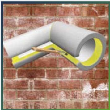
Нанесите на склеиваемые поверхности клей THERMAFLEX.
