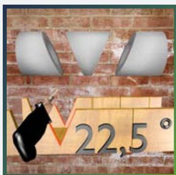
Отрезок достаточной длины трубной изоляции THERMAFLEX разрежьте на сегменты как показано на рисунке.
