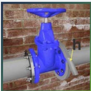
Используя узкую полоску изоляции, измерьте диаметр трубы.
