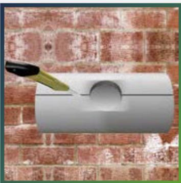
Теплоизоляционную деталь, подготовленную ранее для монтажа основного участка трубопровода, разрежьте вдоль по всей длине, проходя через центр выполненного пробойником отверстия.
