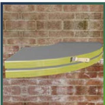
Сложите обе детали вместе и нанесите ровный тонкий слой клея THERMAFLEX на подлежащие склеиванию торцевые поверхности большего радиуса полученных деталей.
