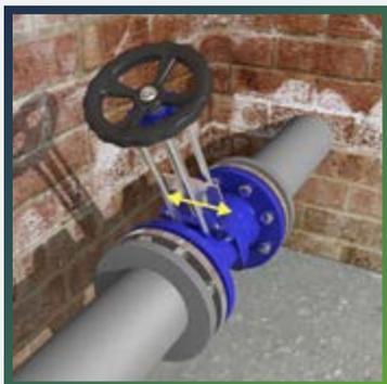
С помощью кронциркуля измерьте диаметр горловины вентиля. С использованием узкой полоски теплоизоляции измерьте длину окружности фланцев.
