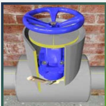
Нанесите клей на все соединяемые торцы теплоизоляции.
