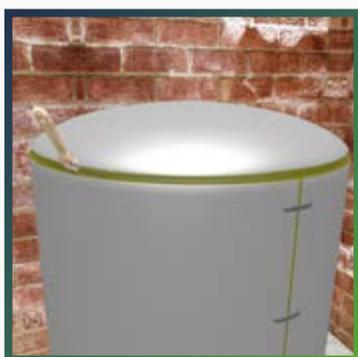
Тщательно проклейте места стыка изоляционной крышки с изоляцией стенок резервуара.
