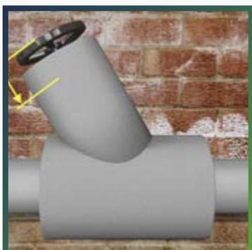
Измерьте расстояние от колеса крана вентиля до изоляции, смонтированной на механизм вентиля с допуском 3-6 см.
