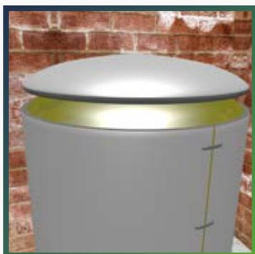
Нанесите тонкий ровный слой клея THERMAFLEX на всю поверхность вырезанной детали.
