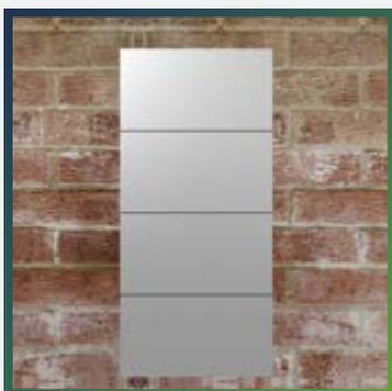
Полученные измерения перенесите на лист теплоизоляции. Для этого разделите лист на 4 части на расстоянии четверти длины окружности фронтального фланца.
