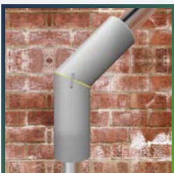
Прижмите и при необходимости зафиксируйте стыки монтажными клипсами THERMACLIPS. Проклейте швы армированным скотчем POLYKEN для герметизации соединений.
