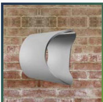
Срежьте кромки кривой линии под углом  $45^\circ$  по направлению к той стороне, которая будет внутренней при монтаже.
