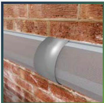
Для герметизации соединений проклейте швы самоклеящейся лентой THERMATAPE.
