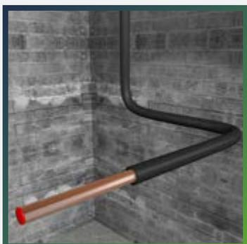
Натягивать изоляцию следует осторожно, не создавая излишнего давления, которое может привести к деформации трубной теплоизоляции.
