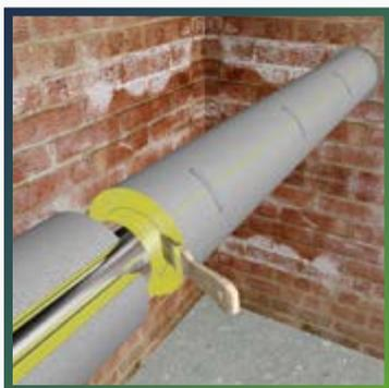
Для продолжения монтажа нанесите клеевой слой на торцевые поверхности уже смонтированной теплоизоляционной трубки и на часть прилегающего трубопровода.
