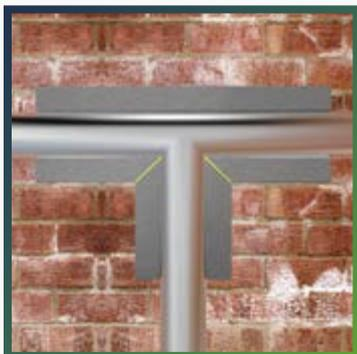
Для монтажа изоляции на Т-образном соединении труб равного диаметра следует подобрать трубную теплоизоляцию подходящего размера, разрезать её на два куска, один из которых будет занимать треть всей длины трубки, а второй – две трети.
