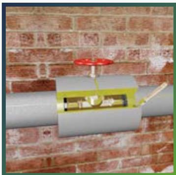
Установите полученную деталь в соответствующее место, провед ножку крана в круглое отверстие. Тщательно склейте все места разреза и места стыка с изоляционной подложкой, используя клей THERMAFLEX, прижмите.
