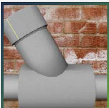
С помощью узкой полоски изоляции измерьте длину окружности полученной изоляционной детали. Нанесите на изоляционный лист полученные размеры, вырежьте полоску, затем – круг с диаметром, равным диаметру колеса крана вентиля.
