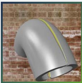
Когда клей слегка подсохнет, постепенно прижимайте торцы теплоизоляционных деталей друг к другу от краев к центру, чтобы избежать перекосов. Особенно тщательно проклейте центральную часть шва.
