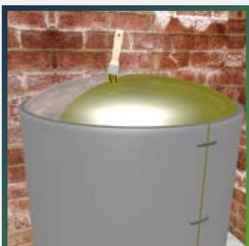
Нанесите на всю поверхность крышки резервуара тонкий ровный слой клея THERMAFLEX.
