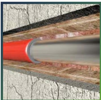
Смонтируйте теплоизоляционную трубку Thermacompact IS соответствующего диаметра на трубопровод методом натяжения: не прикладывая больших усилий, волнообразными движениями протягивайте изоляцию по поверхности трубопровода. Натягивать изоляцию следует осторожно, не следует создавать излишнее давление – это может привести к деформации теплоизоляционной трубы.
