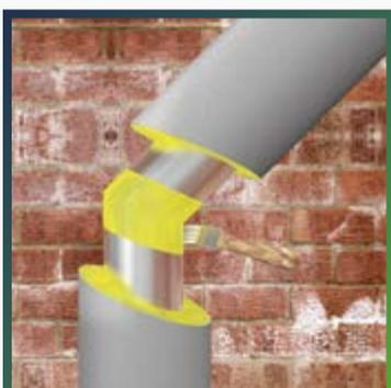
Аккуратно, волнообразными движениями, без усилий, натяните полученные фрагменты на трубопровод, предварительно нанеся клей на торцы изолирующих фрагментов и на поверхность трубопровода в месте стыка для фиксации теплоизоляционного материала.
