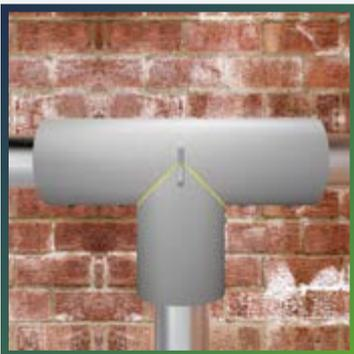
При необходимости зафиксируйте швы монтажными клипсами THERMACLIPS. Через 24 часа, после полного высыхания клея, снимите клипсы и проклейте швы армированным скотчем POLYKEN для герметизации соединений.
