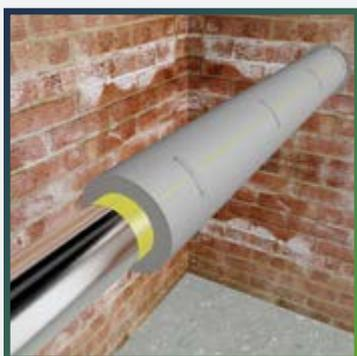
При необходимости временной фиксации шва, используйте монтажные клипсы THERMACLIPS, закрепляя их через каждые 20 см. В наиболее напряженных местах склейки интервал расположения клипс может быть уменьшен.
