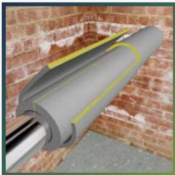
Выполните монтаж первого (внутреннего) слоя теплоизоляции (см. п. 8.3 или п. 8.12 в зависимости от диаметра трубопровода – менее или более 159 мм). Очистите поверхность первого слоя теплоизоляции от грязи, пыли и жира.
