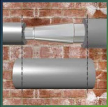
Отрежьте фрагмент трубной теплоизоляции, внутренний диаметр которой равен внешнему диаметру большего участка трубопровода. Длина отрезанного фрагмента должна превышать изолируемый участок на 2-3 см.
